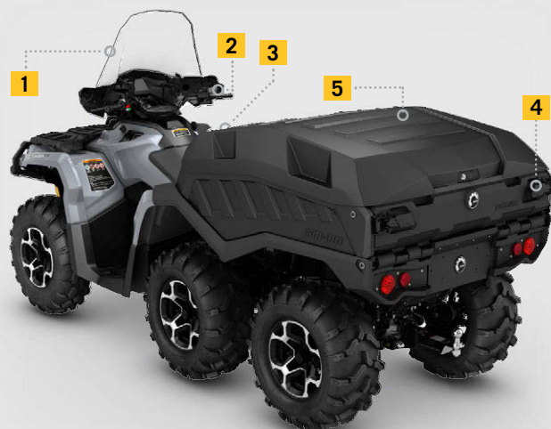
WINTER PACKAGE 1. Extra hög deluxe vindruta 2. Uppvärmade handtag och tumgasreglage 3. Uttag till elvisir 4. Sidoväggar och baklucka 5. Hårt tak
