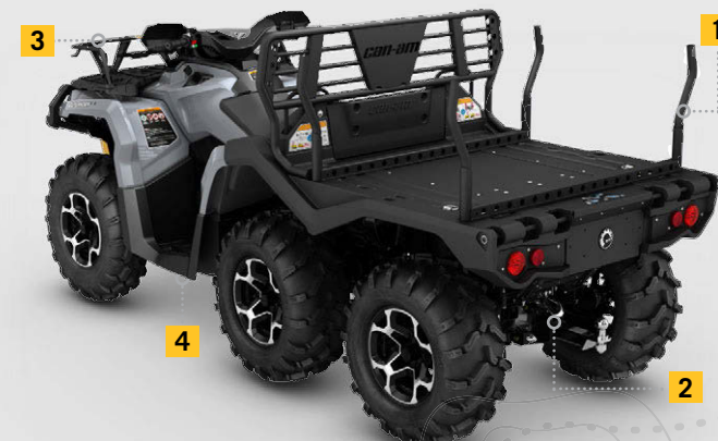
FORESTRY PACKAGE 1. Timmerstötter 2. Bakre vinschkit 3. Främre LinQ-räcke, 15 cm 4. Heltäckande hasplåt i 9 mm polyeten
