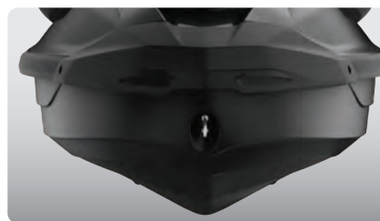
GTI-skrov Detta V-formade skrov ger en stabil, njutbar tur i varierande sjöförhållanden. Säker, pålitlig manövrering men otroligt lekfull att köra när du så önskar.
