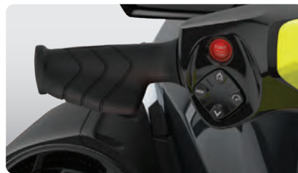
VTS™ (variabelt trimsystem) Inställningar som aktiveras från styret gör att föraren snabbt kan hitta en idealisk trimning för varierande förhållanden.
