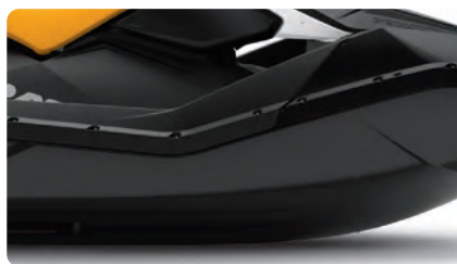
Polytec™ Innovativt material som minskar vikten samtidigt som prestanda och effektivitet ökar. Den infärgade gjutningen är reptäligare än glasfiber.
